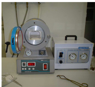
Figura 2 – Mufla utilizada para tratamentos térmicos em amostras de quartzo
