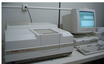
Figura 3 – Espectrofotômetro Cary 1G Varian para medidas de Absorção óptica.
